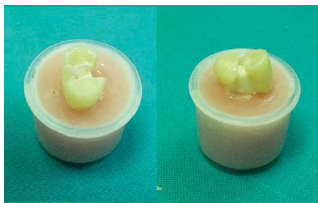
Sl. 8 – Lom keramičke kruna pod dejstvom opterećenja
