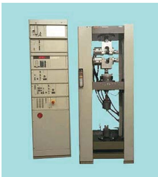
Sl. 6 – Uređaj za ispitivanje otpornosti materijala tipa "Zwick 1464" (Zwick, Germany)
