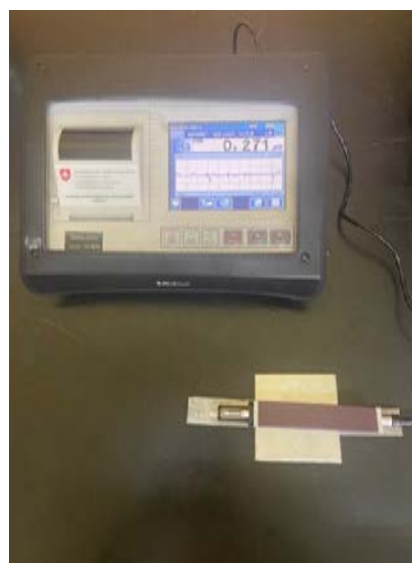
Fig. 4 – Mitutoyo SJ-310 profilometer.
